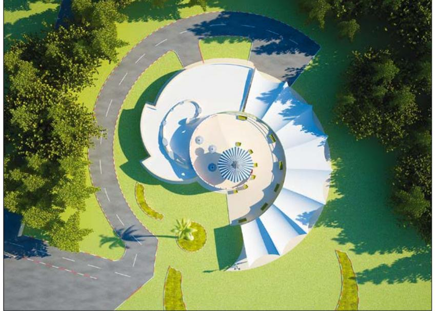
Die organischen Formen der Architektur von Djanan sollen überwiegend in Earth-Bag-Bauweise entstehen. Dabei werden Nylonsäcke im Abstand von 20 cm in einem Gestell aufgehängt, von oben mit Lehm befüllt und dieser dann festgepresst. Für den Oberputz werden ebenfalls Lehm sowie Bast oder Maschendraht verwendet – allesamt preisgünstige Materialien.
