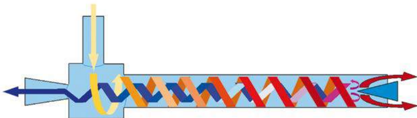
Abb. 9) Das Ranque-Hilsch-Wirbelrohr, ist eine Vorrichtung ohne bewegliche Teile, mit der sich Gas in einen heißen und einen kalten Strom aufteilen lässt. Unter Druck stehendes Gas wird tangential in eine Wirbelkammer eingeblasen und in eine schnelle Rotation versetzt (über 1 000 000/min). Der Gasstrom teilt sich aufgrund der hohen Fliehkräfte und weiteren, noch nicht vollständig verstandenen Prozessen in einen äußeren warmen und einen inneren kalten Strom auf. Das Wirbelrohr wurde 1933 von dem französischen Physiker Georges J. Ranque erfunden. Der deutsche Physiker Rudolf Hilsch verbesserte die Konstruktion.
