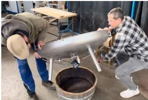
6. Schale mittels Wasserwaage gerade ausrichten. Zulauf Richtung Norden.
