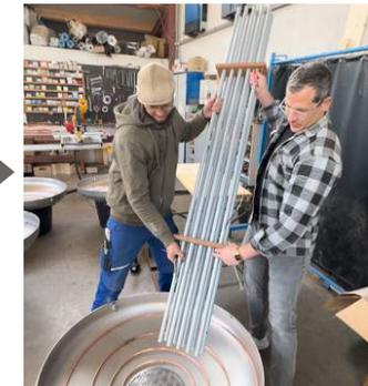
9. Sekundärspule mittels Spannseilen am Rand befestigen
