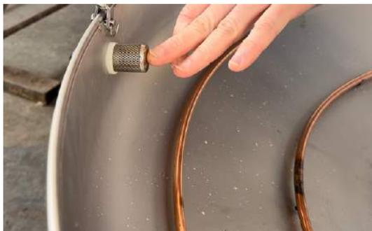
b) Befüllen Sie die Schale bis zum Ablauffilter mit Wasser.
