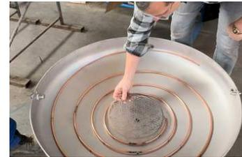
8. Sekundärspule zu zweit aufstellen, mittig positionieren und ausrichten (N/W - S/O, oder N/O - S/W).
