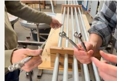
a) An jedem Spanner entfernen Sie den Sicherungsbolzen
