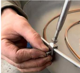
a) Stecken Sie den Sicherungsbolzen ein.
