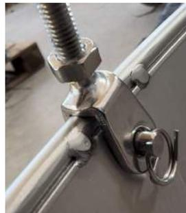
b) Sichern Sie den Bolzen mittels Sicherungsklemme.
