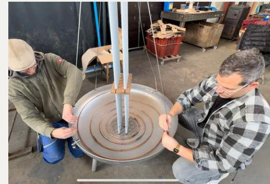
a) Spannen sie die Drähte durch Drehen der Gewindespanner, sodass nur ein leichter Zug entsteht.
