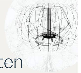
Spannen sie nun die Drahtseile durch mehrfaches drehen der Spanner, solange bis sie auf allen 4 Seiten eine gleiche Spannung erzielen und die Sekundärspule in der vertikalen fest und sicher steht.
