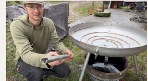
Mit dem "Schlüssel" können Sie den Flügelgriff des Kugelhahns bequem bedienen.
