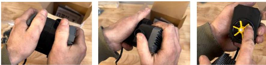
Bei Bedarf können Sie die Pumpe einfach auseinander nehmen und reinigen, indem Sie sie fest mit beiden Händen an den Enden halten und gegeneinander drehen.
